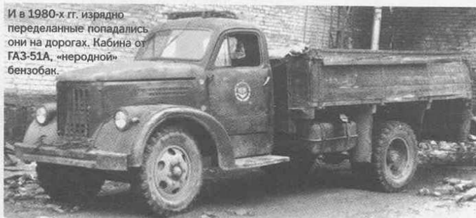
Автокормовоз на базе УралЗИС-355М. Сельхоз. Машино. Краснодарского края
